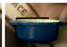
Cuisson de la couleur à 800°C Cooking of colour layers at 800°C
